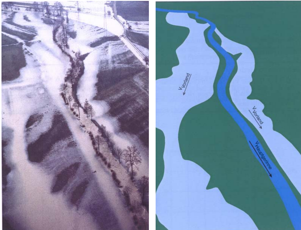
Abbildung 4: Gegliederter Fließquerschnitt bei Hochwasser, Entkopplung von Hauptgerinne- und Vorlanddurchströmung 2
