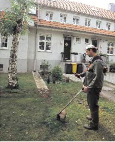
Einsatz Motorsense (Freischneider) im Eckbereich/Böschung
