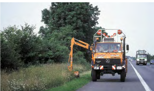
Einsatz Mäher mit Hydraulikschwenkarm bei straßenbegleitender Mulde
