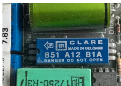
Abb. 2.7.9: Quecksilberhaltiges Bauteil auf einer Leiterplatte
