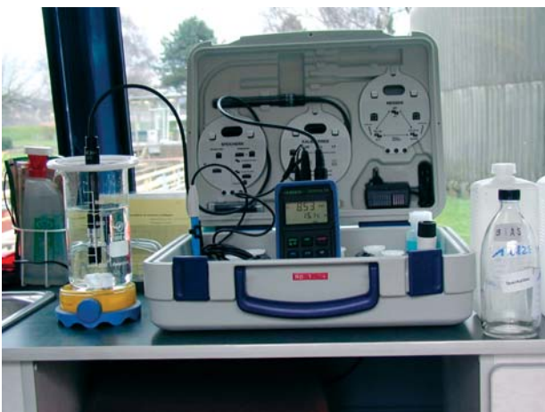
Bild 8: Vor-Ort-Messung im Fahrzeug (Multi-Parameter-Messgerät)
