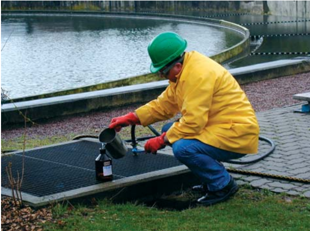
Bild 7: Abfüllen der Stichprobe in die Probenflasche
