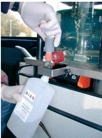
Bild 11: Homogenisierung und Abfüllen von Teilproben
