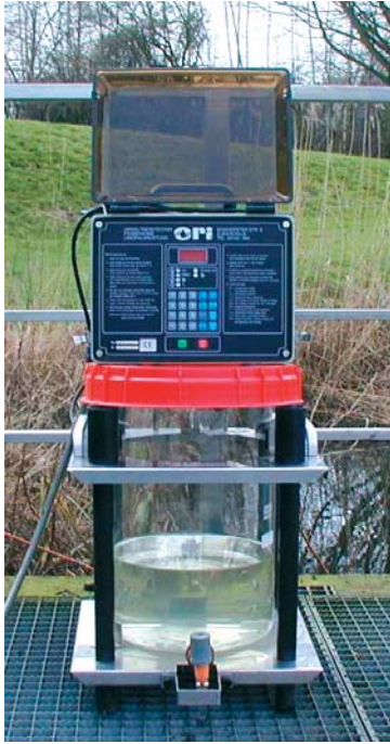
Bild 9: Schlauchpumpensystem mit Direktabfüllung in das Homogenisiergefäß
