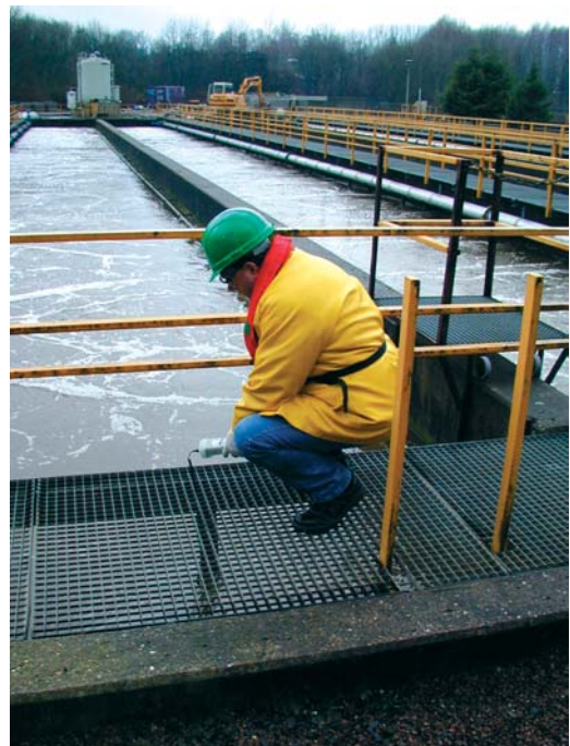
Bild 4: Messung der ammonium-relevanten Abwassertemperatur
