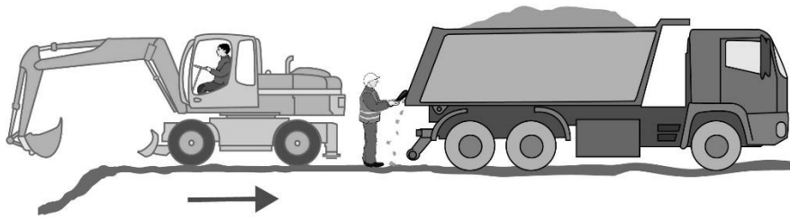
Abb. 2 Gefährdung durch Rückwärtsfahren des Baggers
