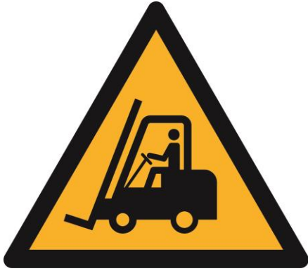
W014 Warnung vor Flurförderzeugen
