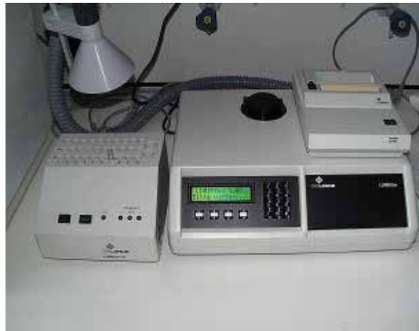
Abb. 8: Luminometer zur Messung der Leuchtintensität im Leuchtbakterien-Hemmtest
