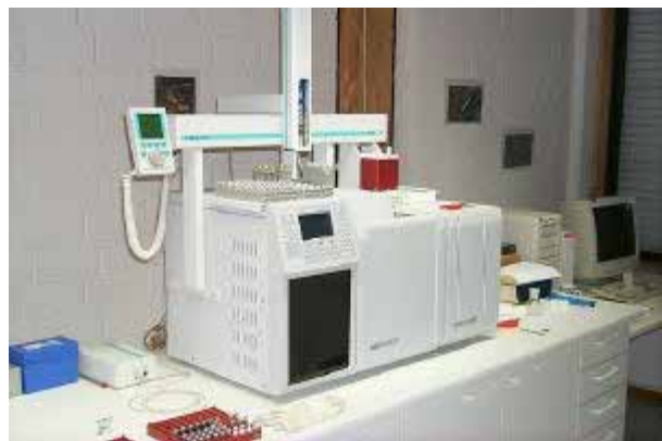
Abb. 1: Gaschromatograph zur chemischen Analyse der Biozide im Limnologischen Institut Dr. Nowak
