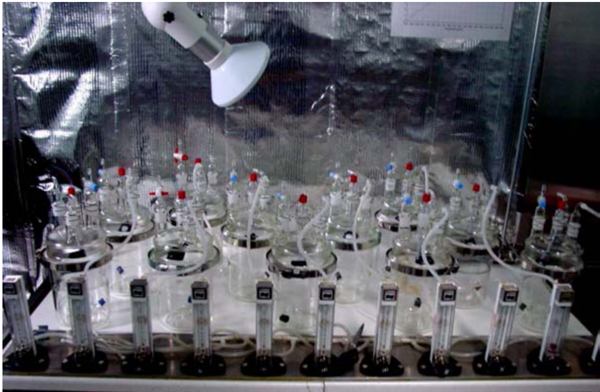
Abbildung 2: Aufbau zur Untersuchung der Beschichtungssysteme
