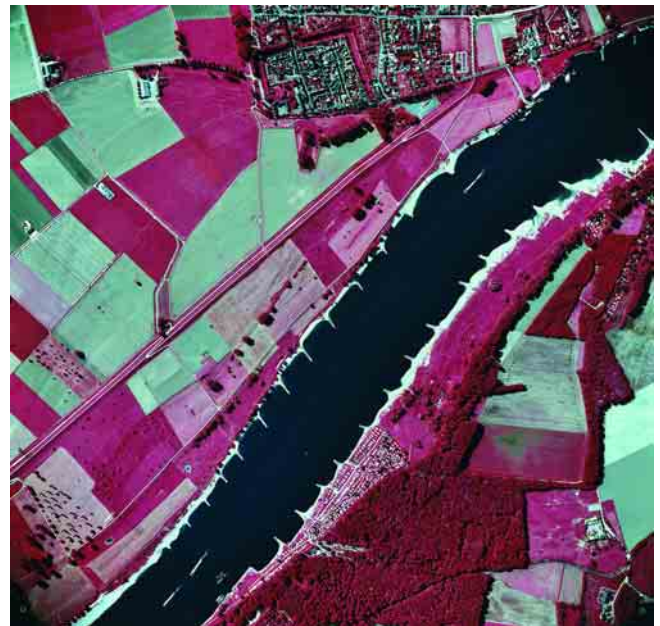
Abb. 28: Buhnenausbau bei Zons.
