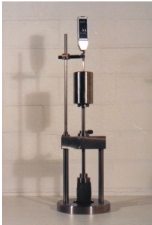
Abb. 5.14: Belastungsrahmen für Deformationsversuche unter Normbeanspruchung ( q_u = 50 \text{ kN/m}^2 )
