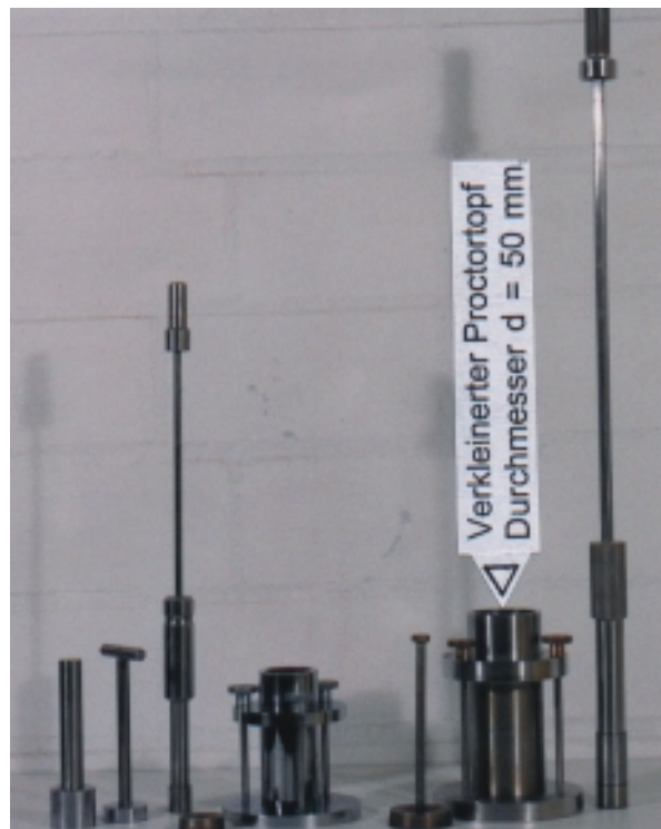
Abb. 8.1: Verdichtungsbehälter und -geräte zur Prüfkörperherstellung bei der Bestimmung der Einaxialen Druckfestigkeit von Schlämmen ( \varnothing 50 mm)
