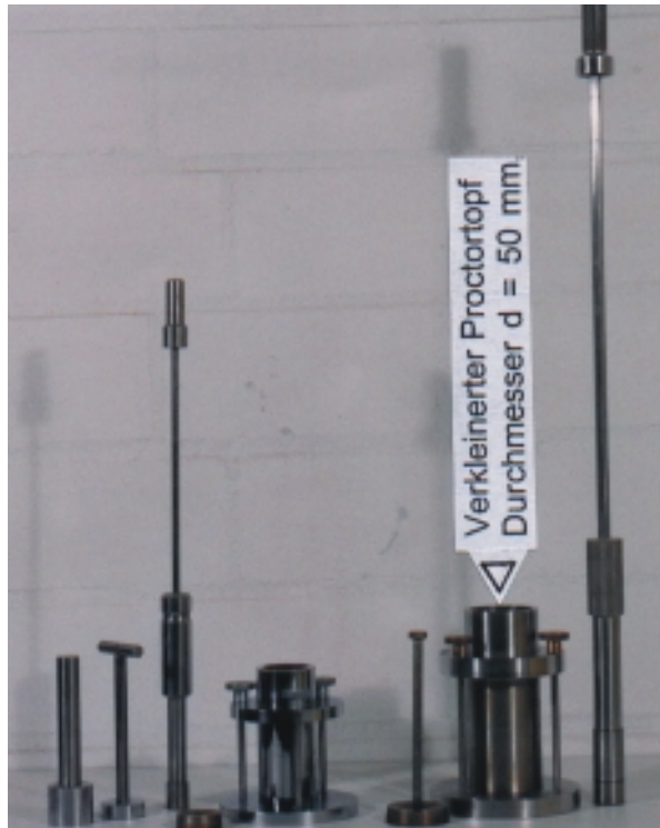
Abb. 5.2: Modifizierte Proctorgeräte ( \varnothing 36 und 50 mm) zur Herstellung von Prüfkörpern für Einaxialversuche
