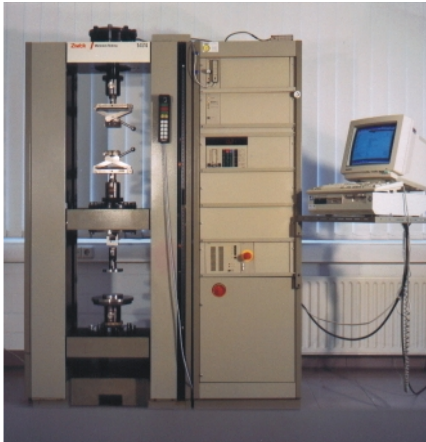
Abb. 5.4: Werkstoffprüfmaschine (Klasse 1) mit Aufnahme der Druck-Stauchungslinie (Geotechnisches Büro, Aachen)
