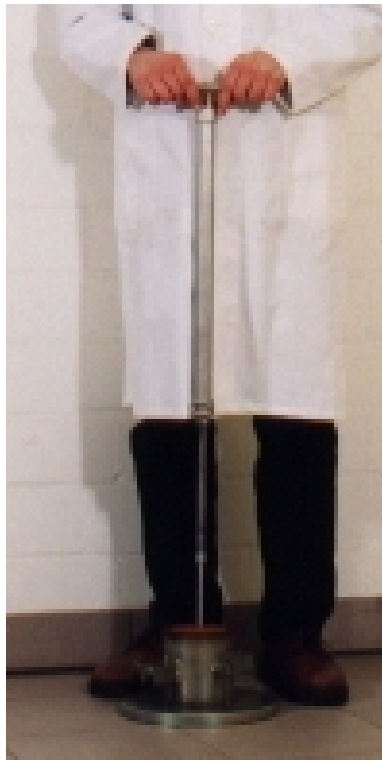
Abb. 5.13: Proctornadel mit Prüfstempel \varnothing 10 mm
