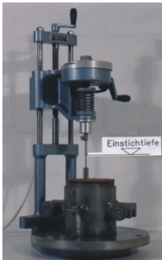
Abb. 8.2: Laborflügelsonde zur Messung von \tau_{FS} (Flügel noch nicht in die Probe eingestochen)
