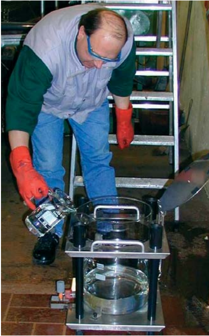
Bild 10: Einfüllen der Probe in das Homogenisiergefäß
