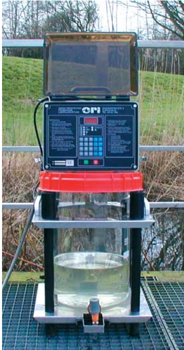
Bild 9: Schlauchpumpensystem mit Direktabfüllung in das Homogenisiergefäß
