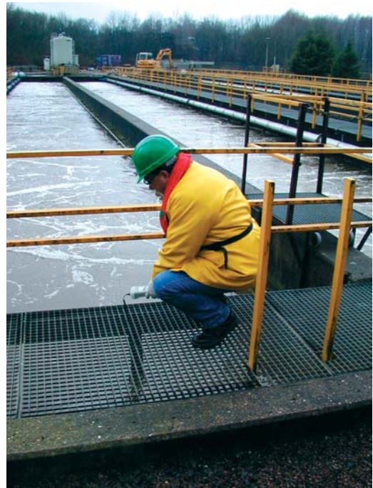
Bild 4: Messung der ammonium-relevanten Abwassertemperatur
