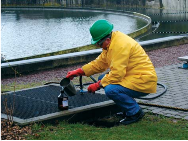
Bild 7: Abfüllen der Stichprobe in die Probenflasche
