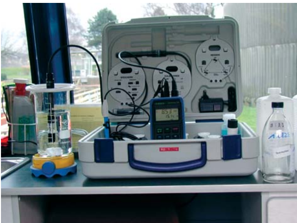
Bild 8: Vor-Ort-Messung im Fahrzeug (Multi-Parameter-Messgerät)
