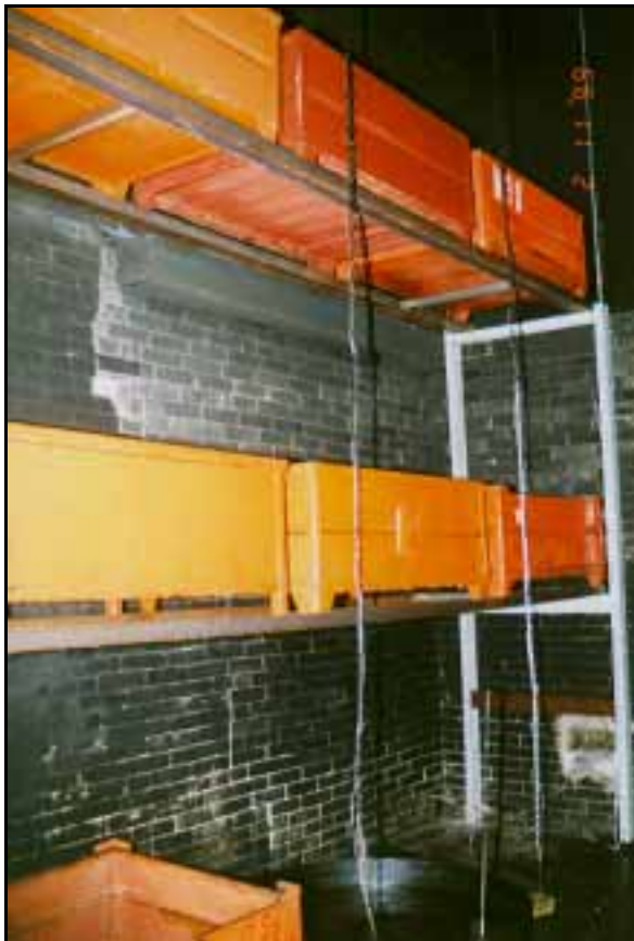
Bild 2.1: Bestückung des Regals auf der Südseite des Brandversuchsraumes
