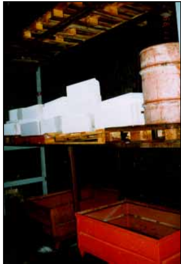
Bild 2.2: Bestückung des Regals auf der Nordseite des Brandversuchsraumes
