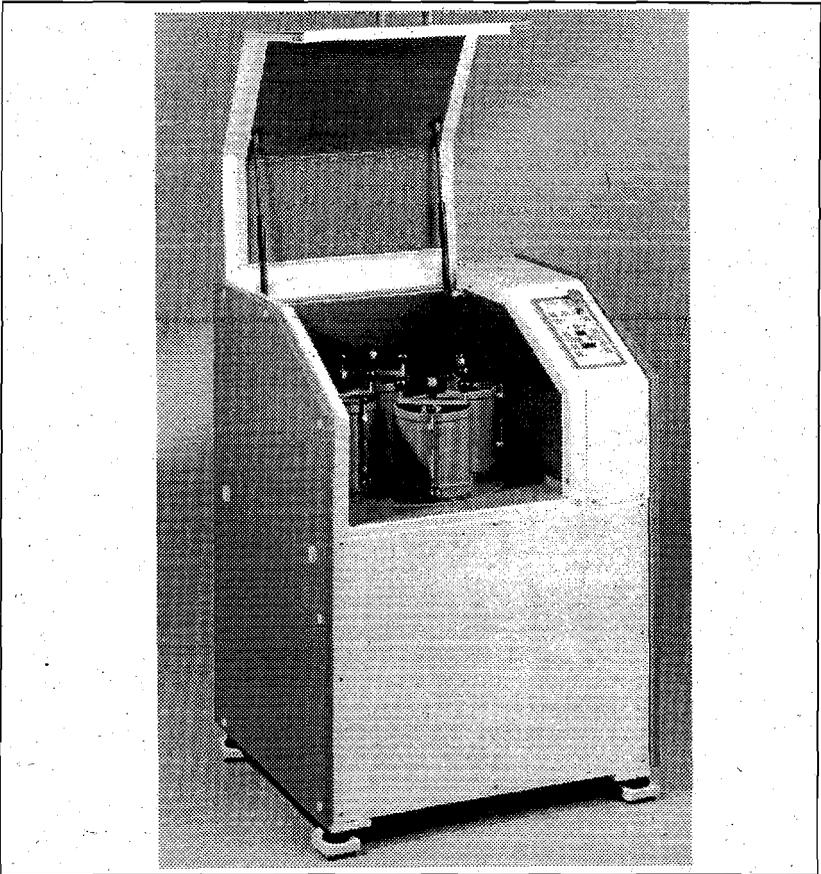
Abb. 2: Planetenkugelmühle
