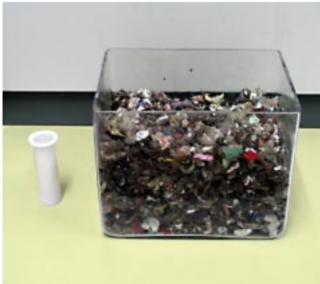
Bild 13: Vergleich von Probemenge rechts und Analyseneinwaage
