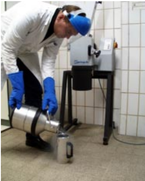
Bild 16: Probenvorbereitung: Tieffrieren des Sekundärbrennstoffes vor der Zerkleinerung. Schneidmühle im Hintergrund.
