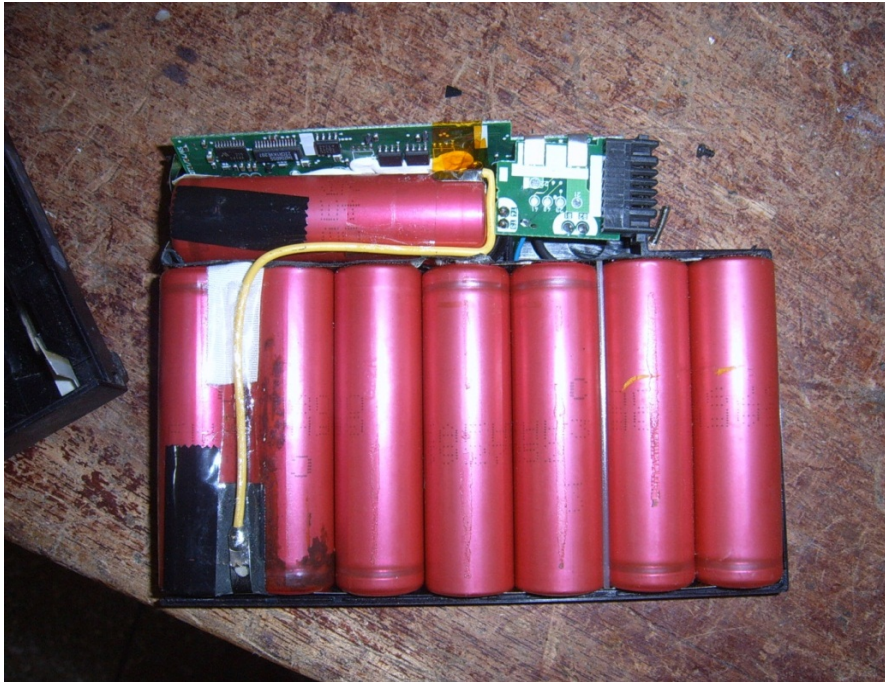
Abbildung 13 Batteriezellen des Akkublocks (eigene Aufnahme Öko-Institut)
