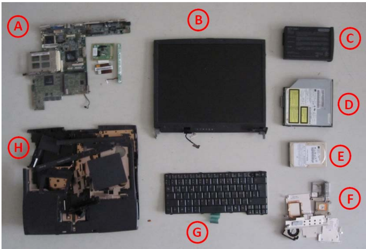
Abbildung 8 Die wesentlichen, aus Recyclingsicht relevanten Komponenten eines Notebooks (eigene Aufnahme Öko-Institut)
