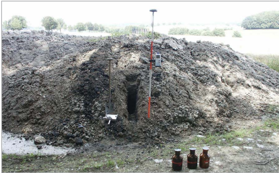
Abbildung 5: Probenahme eines Haufwerkes vom Abfallgemisch mit dem Handelsnamen „Terraform“ in Kellinghausen (Kreis Soest) im Jahr 2006
