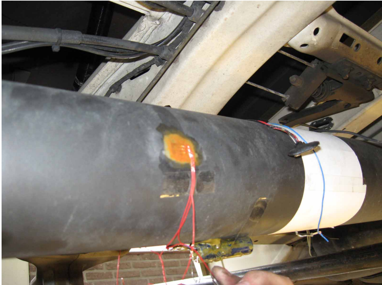
Abbildung 14: Dehnmessstreifen im Rohzustand
