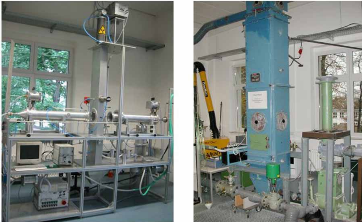
Bild 4: Abtrennung von Feinstäuben aus Luft mittels einer Laborfilteranlage (links) und einer Pilotfilteranlage (rechts).
