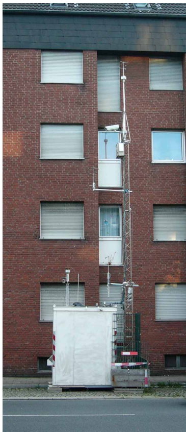
Abb.1: Messmast zur Bestimmung von Partikelkonzentrationen (optische Partikelzähler) und turbulenter Strömung (Ultraschallanemometer) an der Gladbecker Straße (B224), Essen
