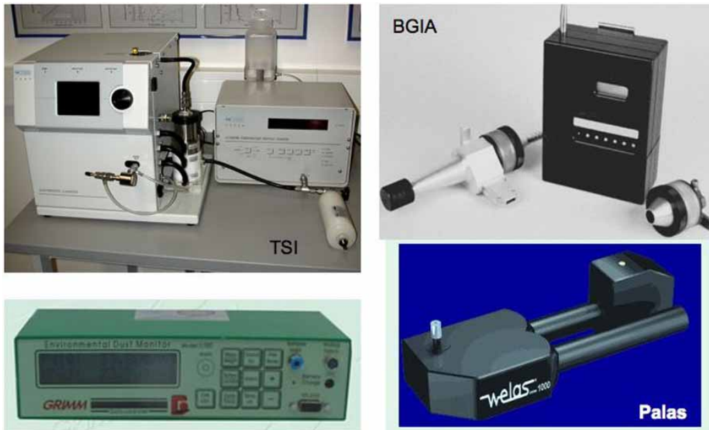
Bild 2: Mobilitätsanalysator (SMPS-System) für den Partikelgrößenbereich von 3 nm bis 950 nm, Trägheits- und filternde Abscheider für einatembaren und alveolengängigen Staub, Aerosolspektrometer zur Ermittlung von PM10-, PM2,5- und PM1-Fractionen, Streulichtpartikelgrößenzählanalytator für Partikel von 0,3 bis 40 \mu\text{m} .
