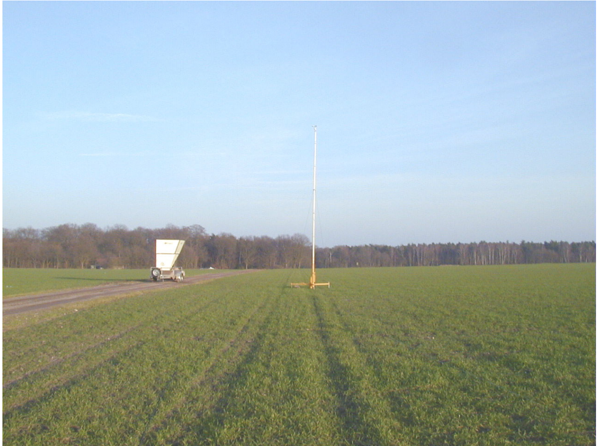
Abbildung A3: 10 m-Anemometer und Sodargerät im Luv der E-70 E4 am 24.02.2007
