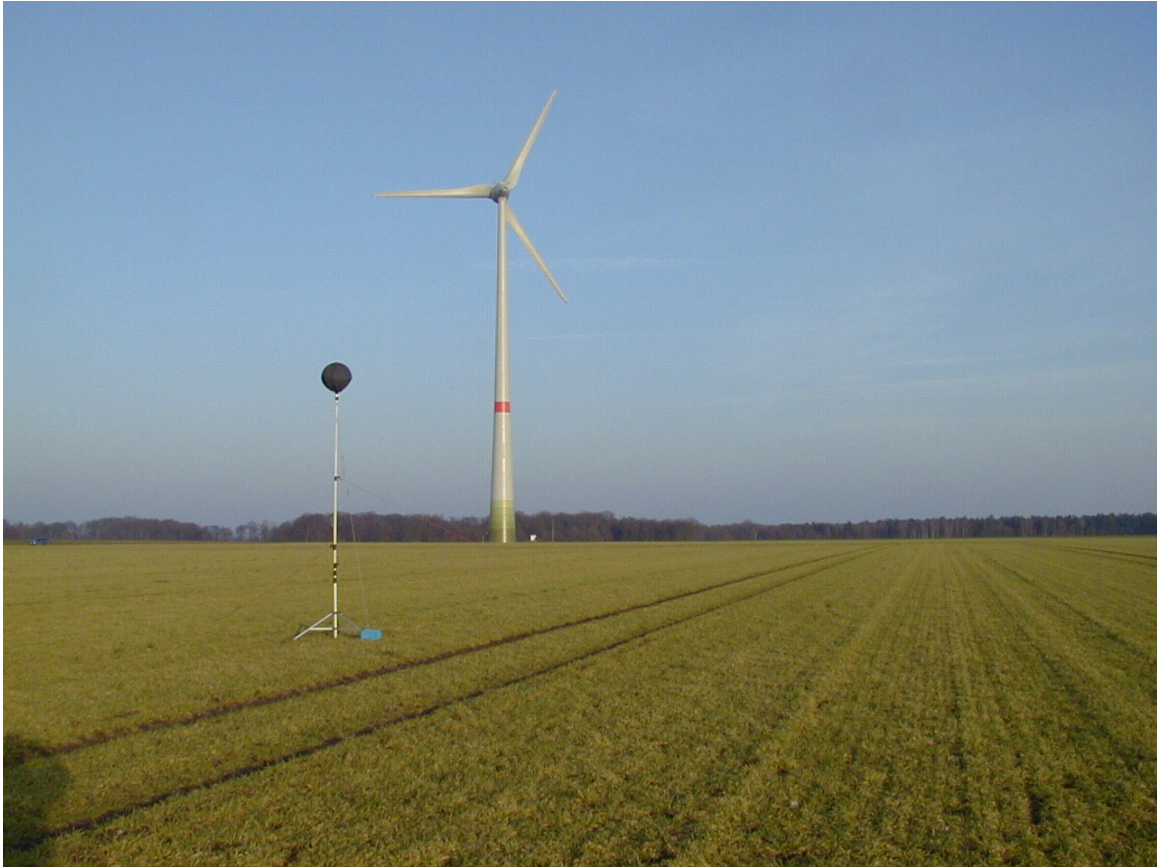
Abbildung A1: Mikrofon auf Stativ (3 m) am Messpunkt der Immission mit Blick zur E-70 E4 am 24.02.2006
