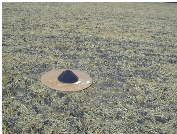
Abbildung A2: Mikrofon am Referenzmesspunkt
