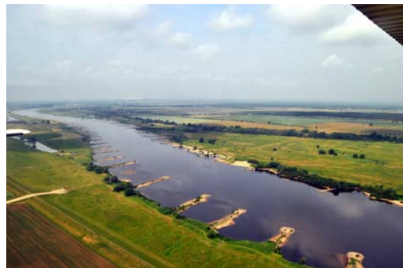
Profil mit Bühnenausbau
