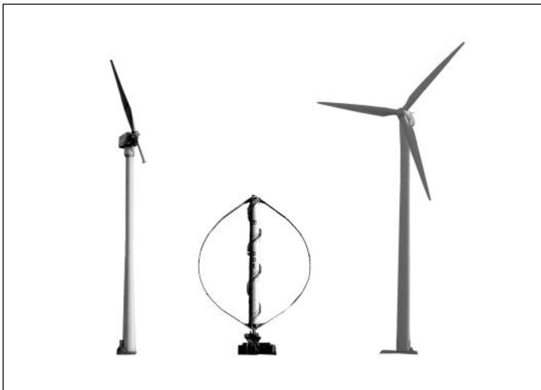
Abb. 7: Einflügler (Monopteros), Darrieus-Rotor und dreiflügelige Horizontalachsenanlage
